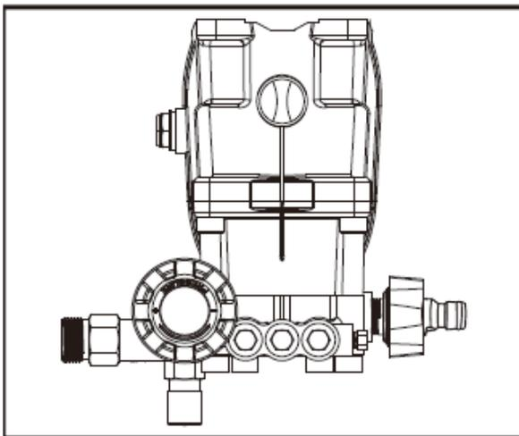
7. Déconnecter le flexible d'eau haute pression du raccord de sortie d'eau du nettoyeur.
