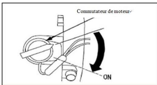
8. Mettre l'interrupteur de l'appareil sur "ON"
