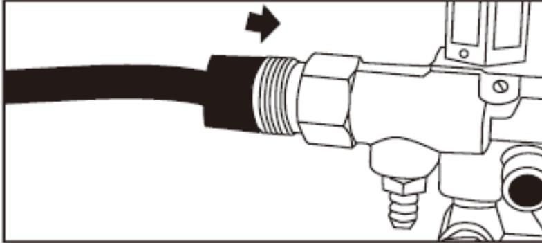
Étape 4:Connecter le flexible au raccord de sortie d'eau du nettoyeur haut e pression.
