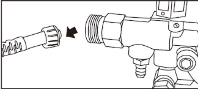
6. Déconnecter le flexible d'entrée d'eau du raccord d'entrée d'eau du nettoyeur.
