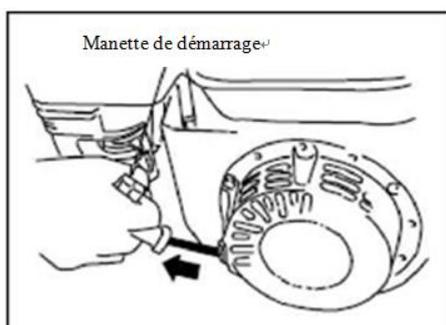
9. Tirez d'abord doucement la poignée du lanceur jusqu'à la butée, ensuite tirer d'un coup sec pour lancer le moteur.
