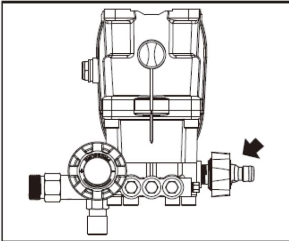
Étape 5: connectez le tuyau d'alimentation d'eau au raccord d'entrée d'eau du nettoyeur.
