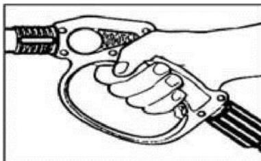
4. Enfoncez la gâchette du pistolet pour chasser l'air hors du nettoyeur et du tuyau, attendez jusqu'à ce que l'eau sortant de la buse soit stable.
