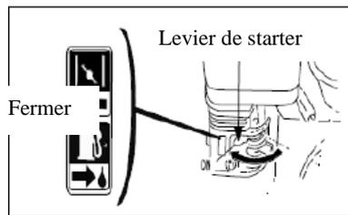
5. Mettre le levier de starter sur la position "ON"
